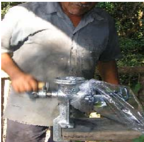
Figura Nº 18. Molino de mano para moler la tinta de añil, Hacienda Los Nacimientos, Aguilares.
