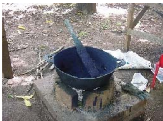
Figura Nº 15. Perol para realizar la cocción de la pasta de añil.
